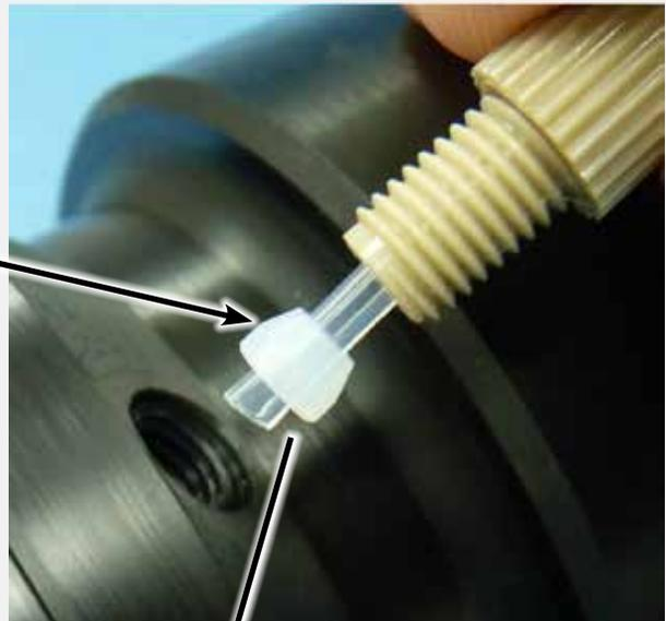
Durante il montaggio del raccordo di lavaggio della coppa, assicurarsi che l'estremità rastremata della ghiera venga inserita nel raccordo di lavaggio della coppa.
