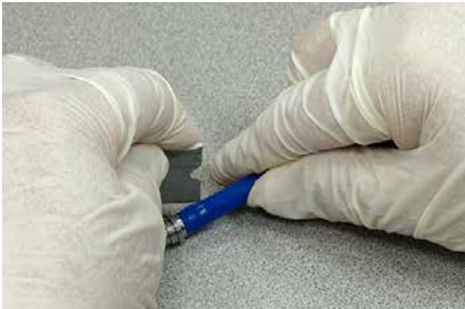
Schlauch von Schutzschlauch abschneiden und Schläuche entfernen.
