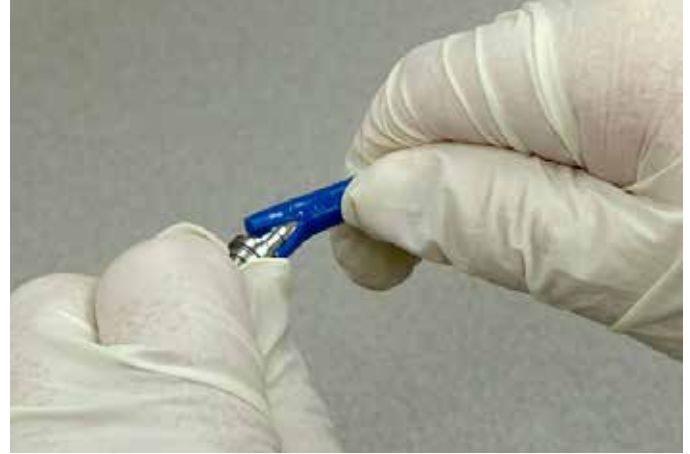
Beschädigte Schläuche abschneiden und Installationsanweisungen befolgen.
