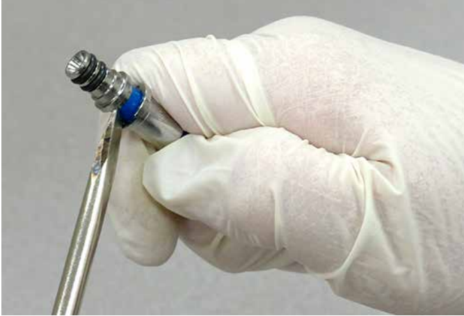
Auseinanderbiegen, bis der Empfänger von der Schlauch- und Schutzschlauchbaugruppe getrennt ist
