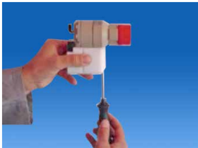
6. Sujete la pistola en la parte delantera con el tornillo.
