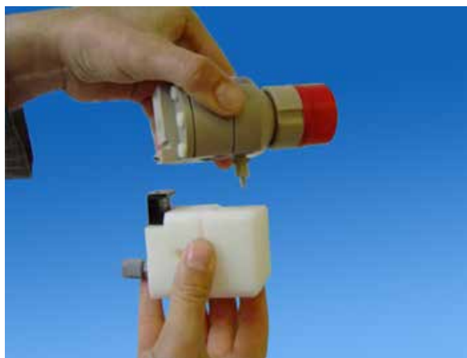
1. Posicione la pistola a 45° en relación con el adaptador.
