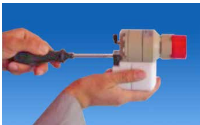
5. Sujete la pistola en la parte trasera con el tornillo.
